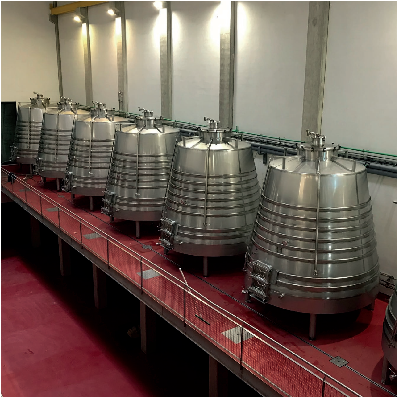
Can Axartell, Mallorca. Depósitos de fermentación troncocónicos, Ver página 116.
